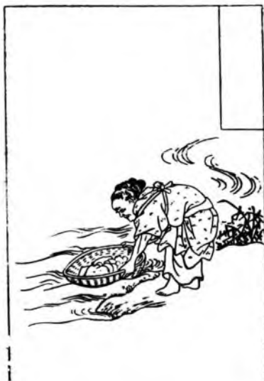
Разбитая палками бумажная масса промывается в реке.
